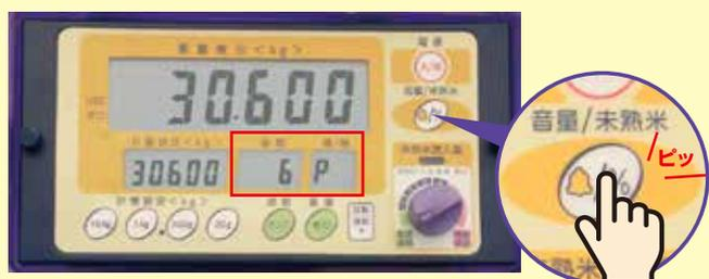
音量 / 未熟米スイッチを押すと、屑米率が表示されます。
