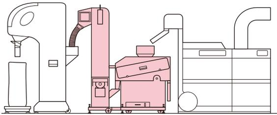
自動選別計量機 ◀ 昇降機 ◀ 石抜機 ◀ 粉すり機
