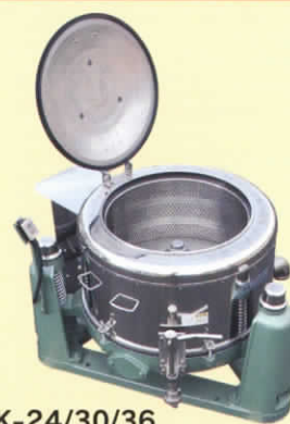
YDK-24/30/36 脱水機 脱水能力: (YDK-24) 25kg / (YDK-30) 38kg / (YDK-36) 60kg モーター出力: 三相200V/ (YDK-24) 0.75kW / (YDK-30) 2.2kW / (YDK-36) 7.5kW
