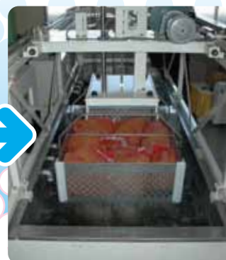
温湯消毒が終了し、冷却槽へ
