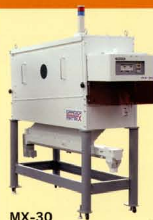
MX-30 種モミ選別機 最大処理能力: 900kg/h (種モミ) モーター出力: 三相200V/ 選別部0.2kW 屑搬送部0.1kW
