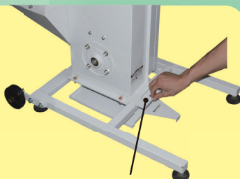
残留米排出シャッター
