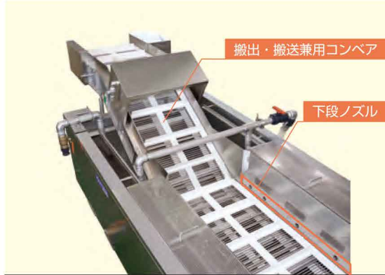
TWS-1300B2/1100B2 下段ノズル＋搬出・搬送兼用コンベア
