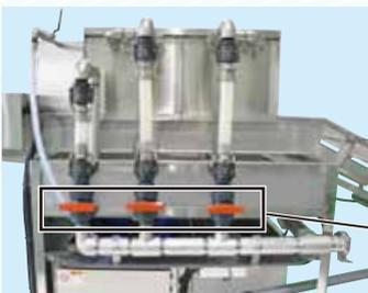
上段・下段のシャワー水はそれぞれ独立しているため、噴射調整バルブの操作で水量の調整ができます。
