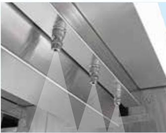
独自の配列によるノズルから噴射する低圧シャワー水が、食品の凹凸にムラなく入り込み、しっかり洗浄します。
