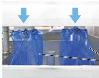
ネットは循環経路に2個取り付けられているため、作業を止めることなく、ネットの交換と異物の回収が交互にできます。
